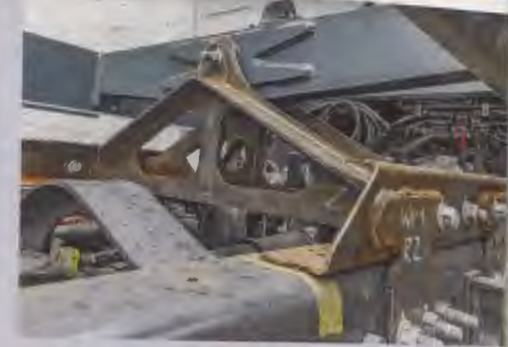
▲ Die dynamische Pendelstützenlagerung der Kabine im Detail
